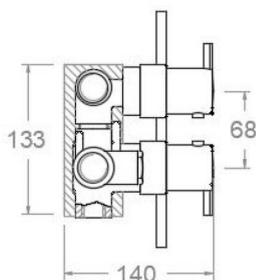
Conjunto empotrado termostático de 2 vías con inversor integrado, sin equipo. Incorpora sistema eficiente Termostop.
