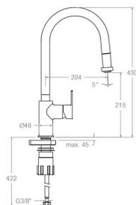
Fregadero de cocina de caño de cisne extraíble con ducha en ABS de 2 jets ( de altura 430 mm, salida de agua a 204 mm ), con sistema S2.
