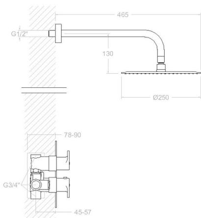
Alexia oro cepillado, conjunto termostático empotrado 1 vía con rociador metálico Ø250mm.
