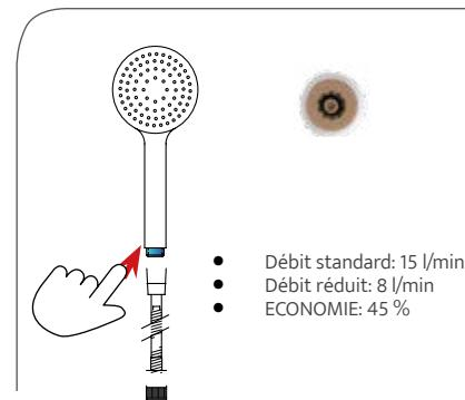
1. Inverseur métallique qu'elle offre une résistance élevée à l'utilisation fréquente et les produits de nettoyage.
