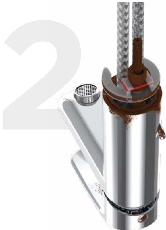
DESSIN 1, RÉSULTAT AVEC ANODE SACRIFICIELLE ZINC-MAGNÉSIUM SUR LA PIÈCE DE FIXATION. L'OXYDATION N'AFFECTE PAS LE CUIVRE DU ROBINET.
